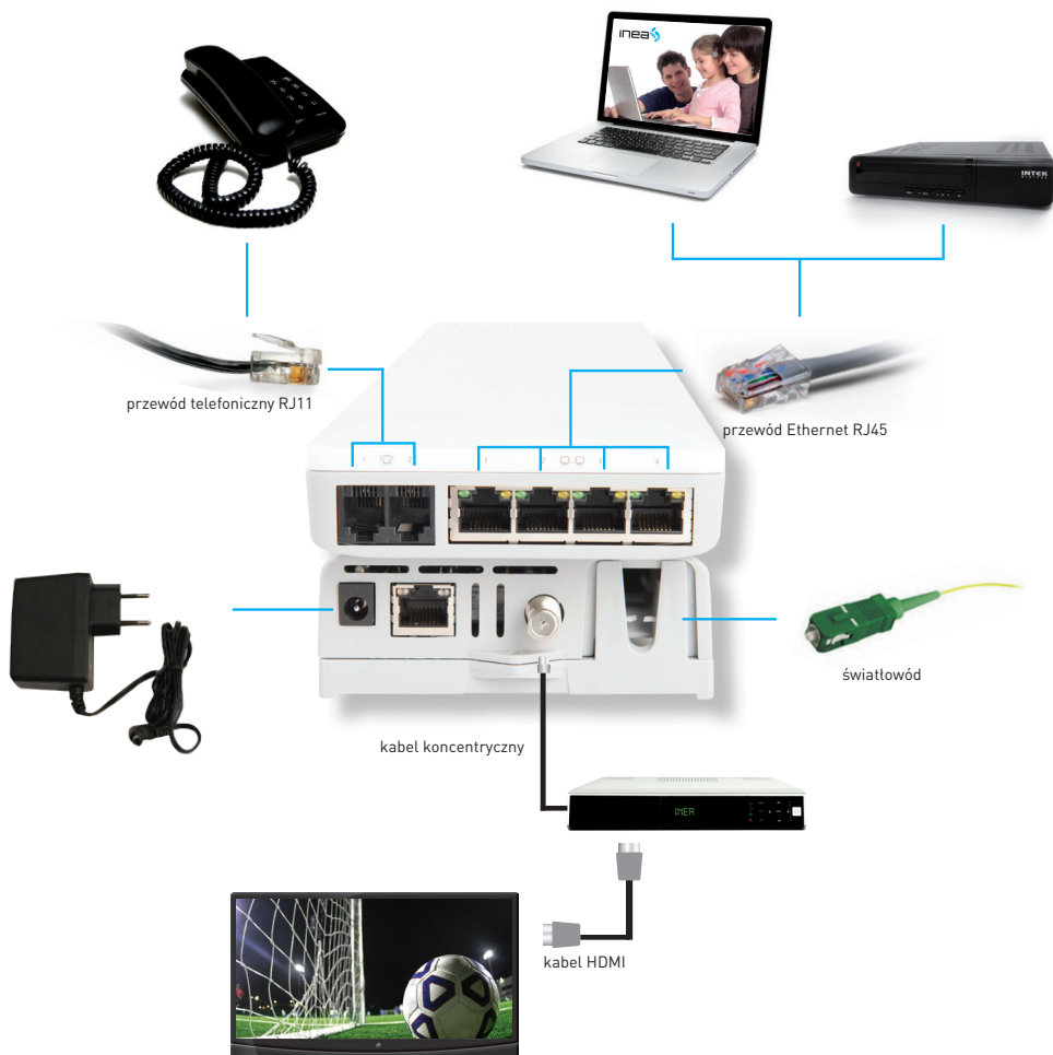
Rysunek 4 Schemat podłączenia modemu
